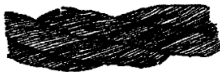
Рисунок 1. Обрывы и смещения проволок каната крестовой свивки.
