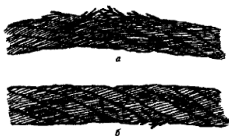
Рисунок 3. Обрывы проволок в зоне уравнительного блока:
