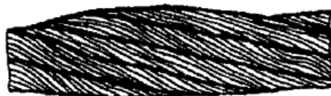
Рисунок 13. Местное увеличение диаметра каната.
